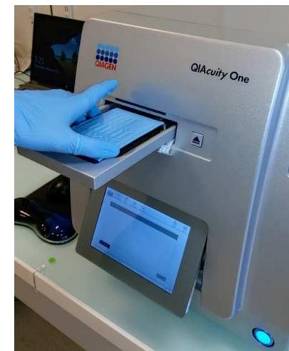
Avec la PCR digitale à partitionnement solide de QIAGEN, profitez d'une mise en œuvre simplifiée pour tracer et quantifier : mélanges réactionnels standards avec multiplexage jusqu'à cinq sondes, transfert des mélanges dans les puits de la 'nanoplate' de votre choix, puis chargement de cette dernière dans l'appareil... et le tour est joué ! Deux heures plus tard, accédez à des quantifications d'une très grande sensibilité et précision.
